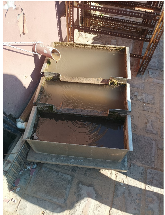
Εικόνα 7: ενδεικτικές διατάξεις (δεξαμενές) για την κατακράτηση του χώματος.
